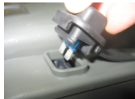
Figuur 1.22 - Accuzekering installeren
