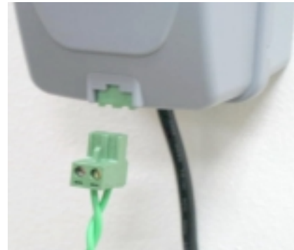
Figuur 1.17 Steek de maaivlakconnector in de perimeterschakelaar
