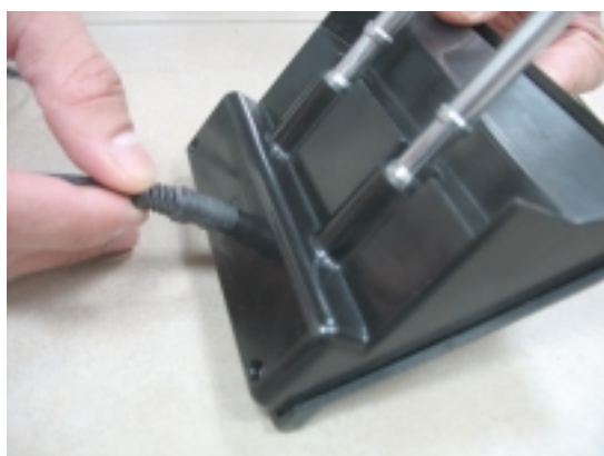
Figuur 3.1 Verbinden van de voeding en de adapter
