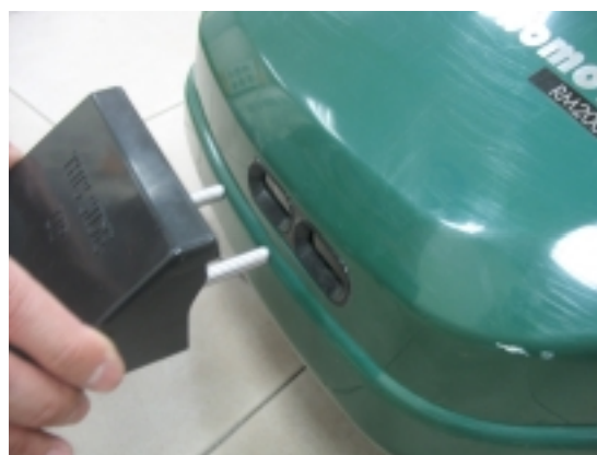
Figuur 3.2 De laadadapter op Robomow aansluiten
