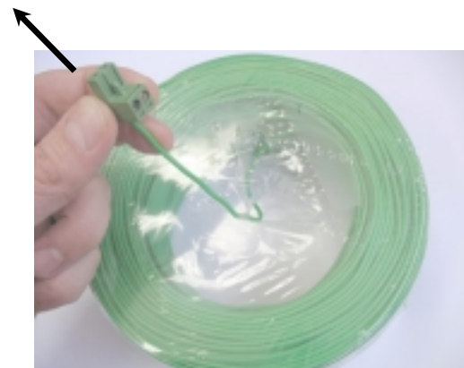
Figuur 1.10 – Trek de draad uit de plastic verpakking – verwijder de verpakking niet; ze is ontworpen om de draad af te wikkelen.
