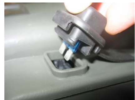
Figuur 1.27 - Accuzekering installeren
