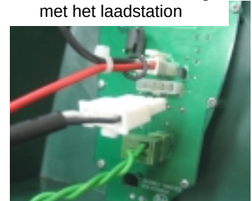
Figuur 1.20 - Aansluiting voedingskabel
