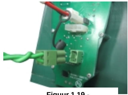
Figuur 1.19 - Perimeterdraad verbinding met het laadstation
