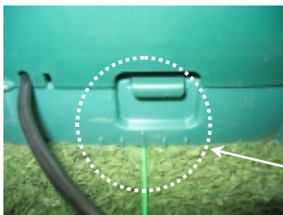
Figuur 1.23 - Laadstation uitlijnen
