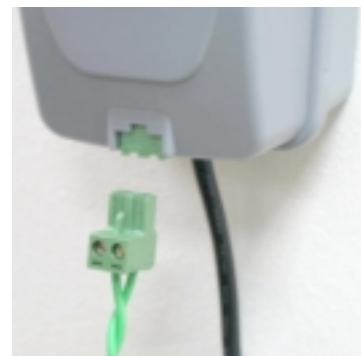
Figuur 1.41 Steek de maaivlakconnector in de perimeterschakelaar
