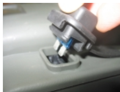
Figuur 1.27 - Accuzekering installeren
