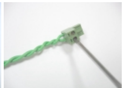
Figuur 1.18 - Draai de schroef vast zodat de draad in de connector vastzit
