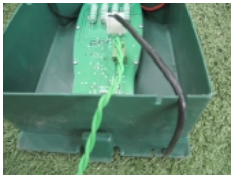
Figuur 1.21 - De voedingsdraad uit het deksel leiden
