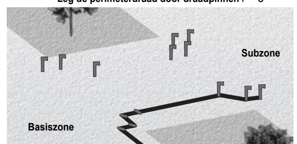
Leg de perimeterdraad door draadpinen 1 – 3
